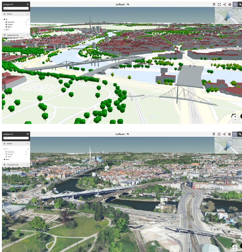
Abb. 4 Abbildungen aus dem Stuttgarter 3D-Stadtmodell, oben: untexturiert; unten: fotorealistische Darstellung durch 3D-Mesh [7]
