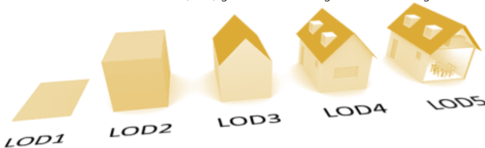
Abb. 6 Level of Detail auf Gebäudeebene (BIM)
